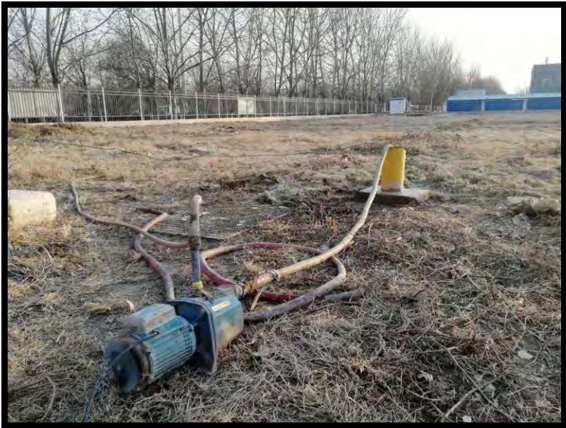
图 5.1-6 抽水试验照片
